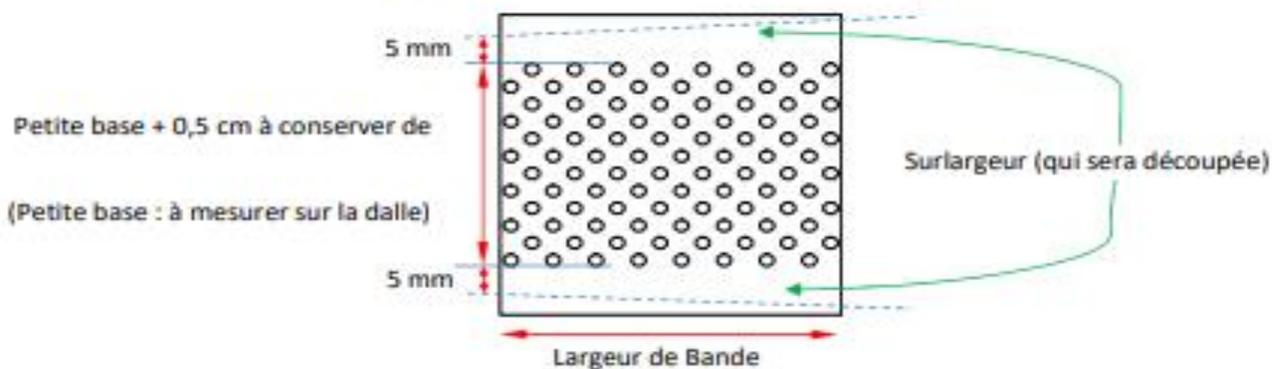
$$\text{Grande Base} = (\text{Petite Base} + 1) \times \frac{R - 50}{R - 50 - \text{Largeur de bande}} \quad ! \text{ C\^otes en cm}$$
